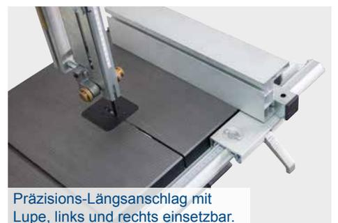
Präzisions-Längsanschlag mit Lupe, links und rechts einsetzbar.
