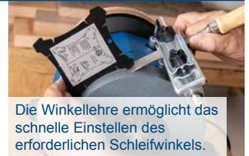
Die Winkellehre ermöglicht das schnelle Einstellen des erforderlichen Schleifwinkels.
