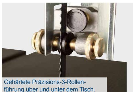
Gehärtete Präzisions-3-Rollenführung über und unter dem Tisch.
