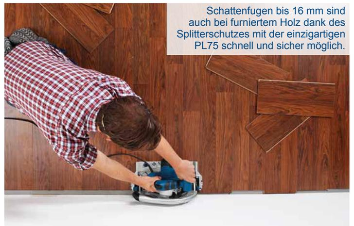
Schattenfugen bis 16 mm sind auch bei furniertem Holz dank des Splitterschutzes mit der einzigartigen PL75 schnell und sicher möglich.
