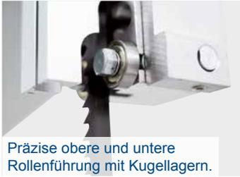
Präzise obere und untere Rollenführung mit Kugellagern.
