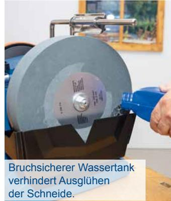
Bruchsicherer Wassertank verhindert Ausfließen der Schneide.
