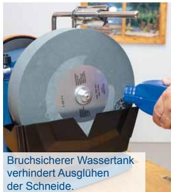
Bruchsicherer Wassertank verhindert Ausglühen der Schneide.
