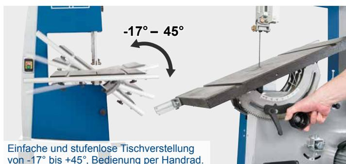
Einfache und stufenlose Tischverstellung von  $-17^\circ$  bis  $+45^\circ$ , Bedienung per Handrad.
