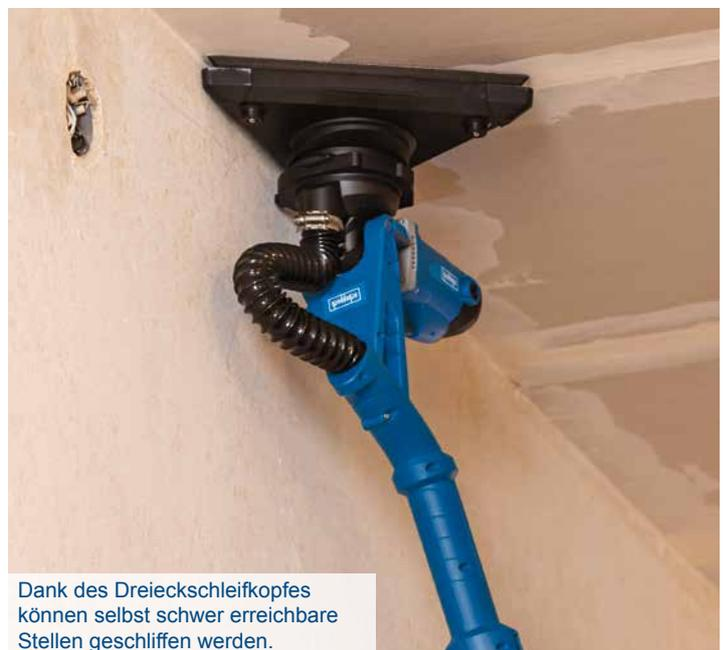
Dank des Dreieckschleifkopfes können selbst schwer erreichbare Stellen geschliffen werden.
