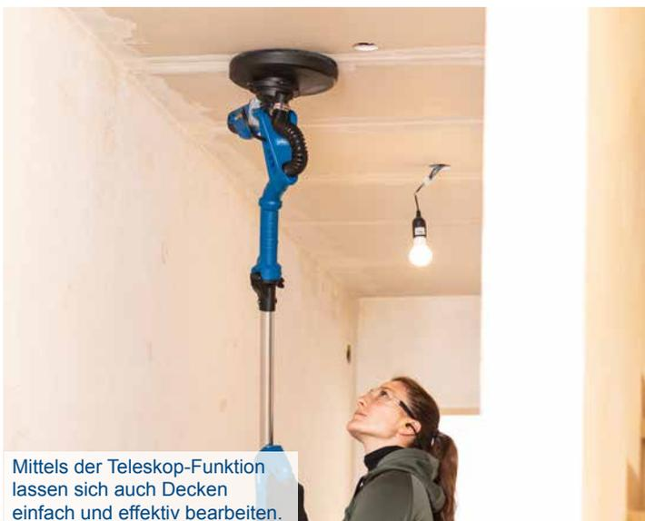
Mittels der Teleskop-Funktion lassen sich auch Decken einfach und effektiv bearbeiten.
